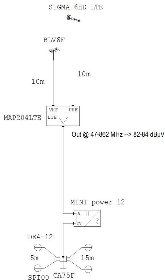
L'indicazione delle antenne, dei supporti porta-antenna e dei preamplificatori da palo nello schema è puramente indicativa, in quanto la scelta dipende esclusivamente dalla tipologia di segnale TV ricevuto nella zona di realizzazione dell'impianto e dalla struttura dello stabile
